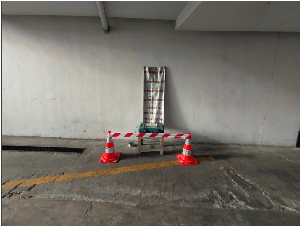
รูปที่ 4-3 แสดงการตรวจวัดความสั่นสะเทือน
